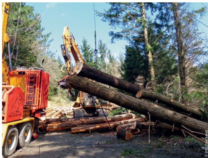
Les bois sont remontés sur la piste où un opérateur les façonne et les trie selon leur qualité
