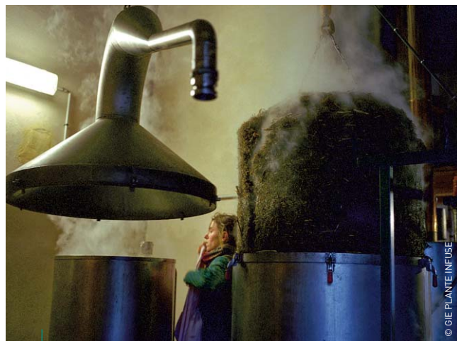
Distillation de plantes récoltées grâce à un alambic afin de produire huiles essentielles et hydrolats
