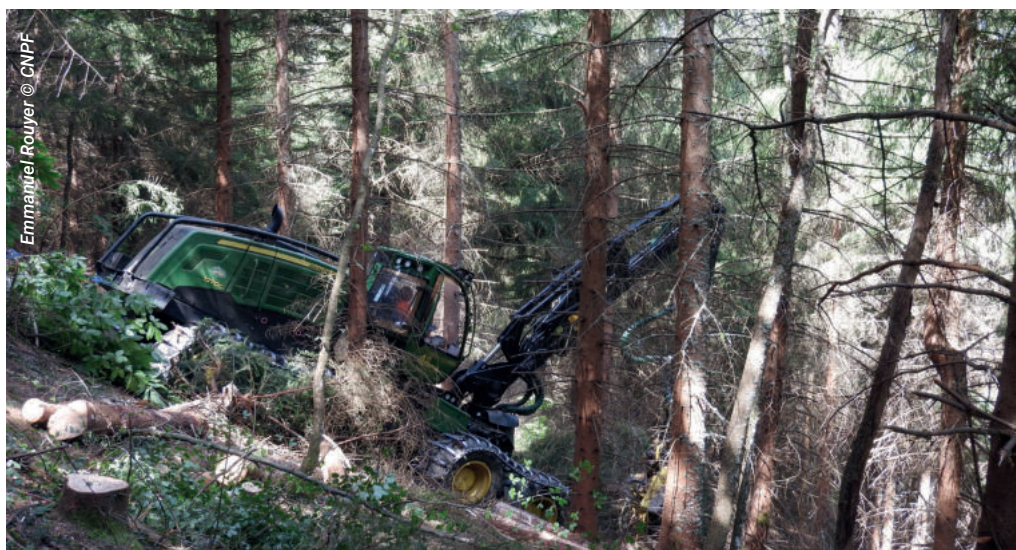
Exploitation de bois sur pente à l'aide d'une abatteuse treuillée
