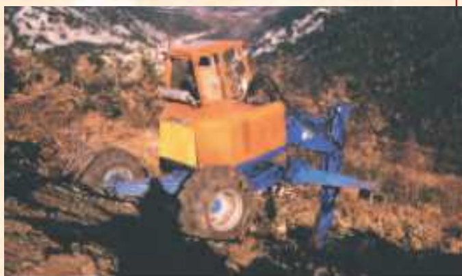
Travail du sol en forte pente : réalisation de potets individuels à la pelle araignée.
